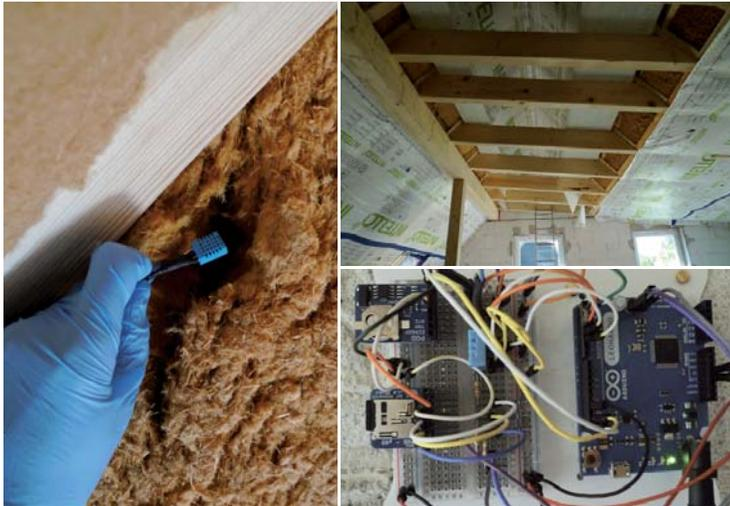
Einbringen der Sensoren in verschiedenen Schichttiefen der Dämmebene des Daches an als kritisch eingeschätzten Punkten z.B. in der Nähe der Mittelfette und an den Anschlüssen zum Altbau. Die Messungen erfolgen alle 10 Minuten und ergeben pro Tag und Messpunkt 120 Datensätze.
