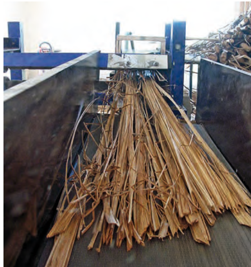
Typha-Stäbe nach Längsschnitt, Foto Typha-Technik
