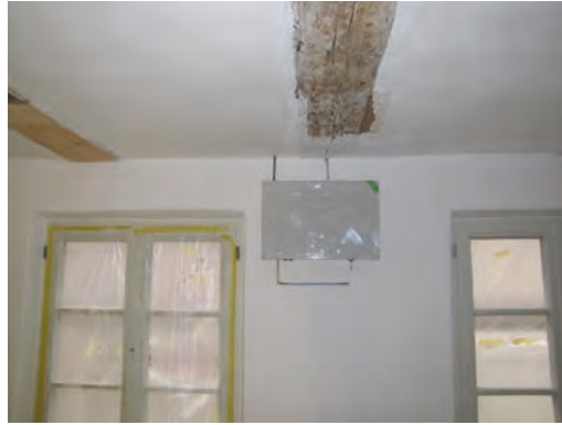
Bild 20: Ansicht nach Fertigstellung im Februar 2011 der mit einem Innenputz versehenen Wand mit endgültiger Position des Gerätekastens, sowie den Oberflächen-temperaturfühler und den Kombisensor für Raumlufttemperatur und -feuchte (im Unterboden des Gerätekastens), Foto IBP
