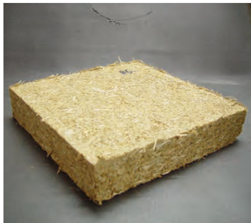
Bild 7: Faserboard mit weitgehend ungerichtetem Material, zusammen mit den Materialkennwerten, Foto IBP
