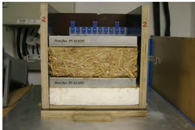
Bild 1: Fotografische Ansicht der Messeinrichtung zur Bestimmung der Wärmeleitfähigkeit, Foto IBP
