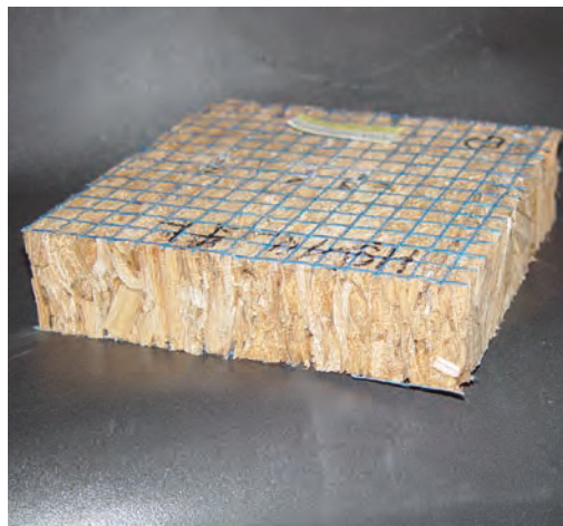
Bild 4: Chip-Board mit überwiegend senkrecht zur Plattenebene orientierten, gröberen Partikel, zusammen mit den Materialkennwerten, Foto IBP
